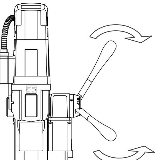
При сверлении кольцевыми сверлами в автоматическом режиме магнитный сверлильный станок определяет, когда отверстие просверлено. Станок автоматически возвращается в начальное по высоте положение и сам выключает двигатель. Если сила магнитного поля недостаточна, функцию автоматического сверления использовать нельзя. Индикатор магнита будет гореть красным светом как предупреждение. В процессе сверления кольцевыми сверлами можно переключаться из ручного режима в автоматический и наоборот.
