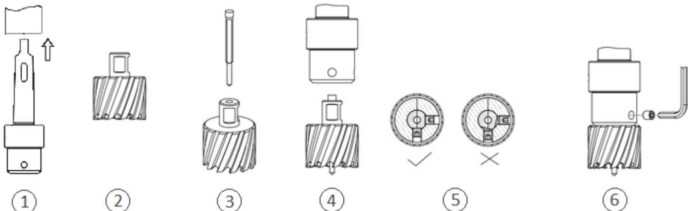
1. В случае, если станок оснащён шпинделем с конусом Морзе, установите идущий в комплекте, либо купленный отдельно патрон Weldon;
